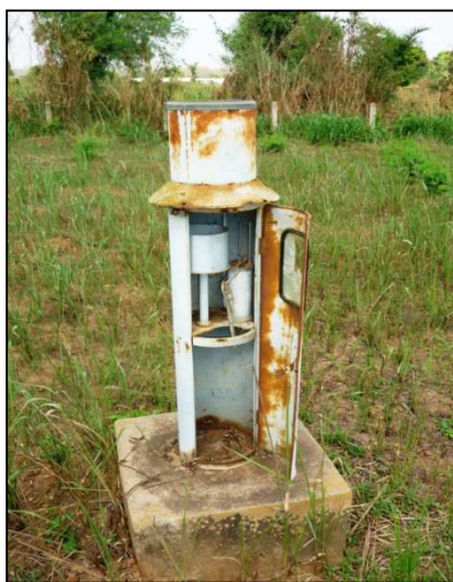
Photo1. Pluviographe en panne /station de Tabligbo Photo 2.Pluviographe, en bon état / station de Lomé
