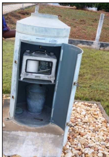
Photo1. Pluviographe en panne /station de Tabligbo Photo 2.Pluviographe, en bon état / station de Lomé
