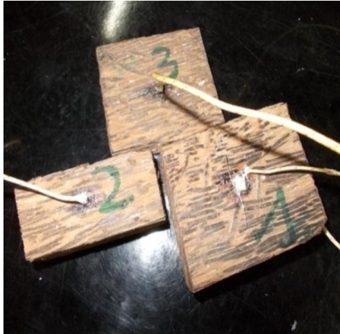
Figure 1 : Epreuves-échantillons pour la mesure de la diffusivité thermique.
