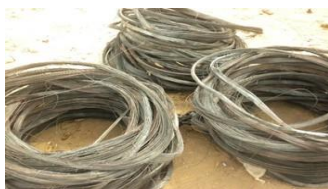
Récupération des métaux des pneus usagés après incinération
