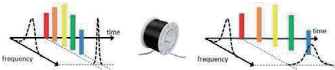
Figure 2.5 : Illustration de l'effet de la dispersion chromatique sur un signal impulsionnel.
