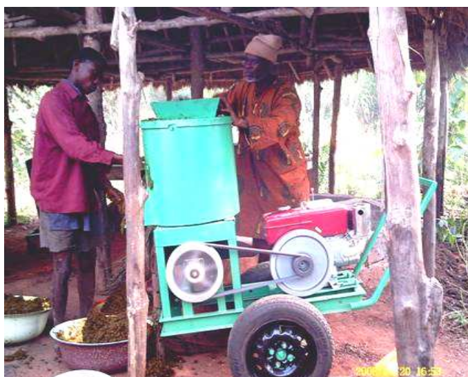
Photo1. Dépulpeur à tambour à axe vertical
