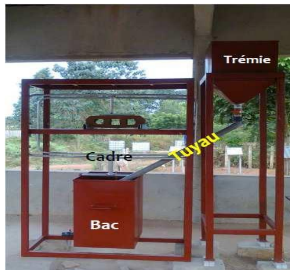
Figure 5 : Dispositif d'essai de poinçonnement flexion
