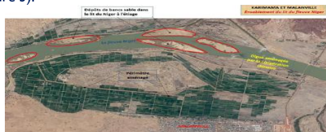
Figure 3 : Bing Image satellite, année 2011 : Ensablement du lit du fleuve Niger à Malanville Source : PNUD-Bénin, 2014
