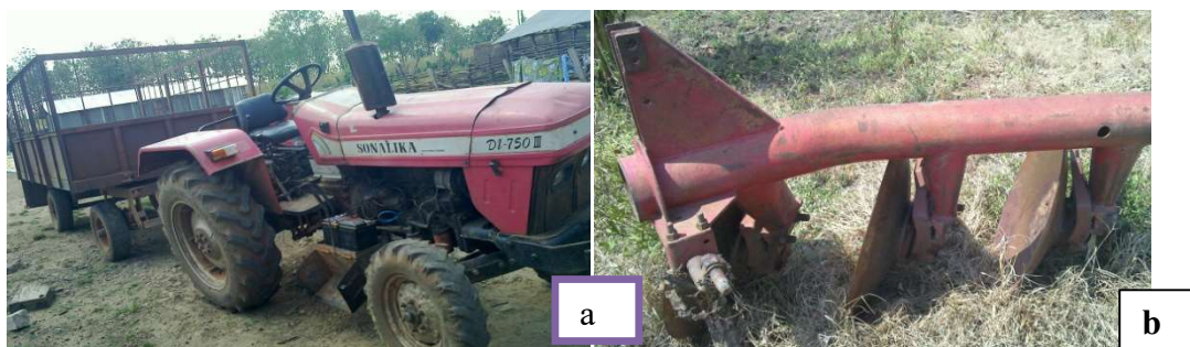
Planche 1 : Tracteur (a) et lame de tracteur endommagée (b) dans un champ à Hontonou
