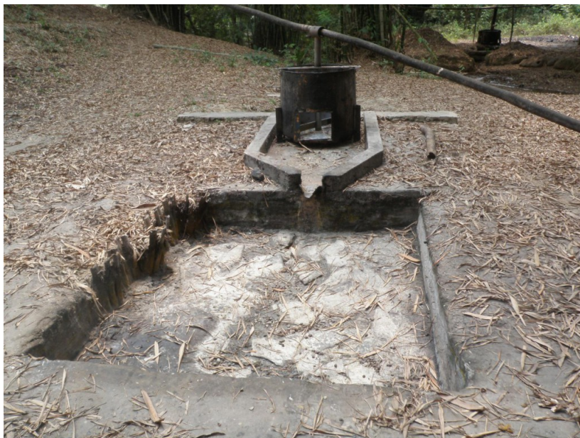
Vue du devant d'un malaxeur avec son trou de recueillement. (Photo : CEPECO Congo)
