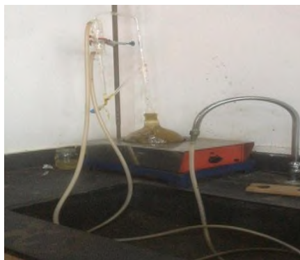
Figure 4 : Dispositif d'extraction des huiles essentielles
