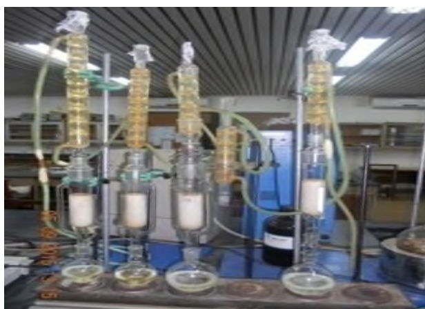
Figure 5 : Dispositif d'extraction au Soxhlet
