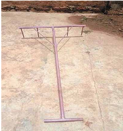
Figure 7. Rayonneur à riz testé en champ-école et co-produit localement. © IRD/A. Sawadogo
