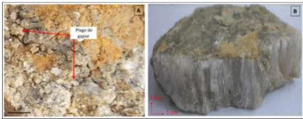
Figure 3: Planche photographique des gypses de Pobè et Ouinhi (A : Cristaux de gypse dispersés dans de l'argile calcaireuse à Pobè, B : Portion de plaquette de gypse de Ouinhi)
