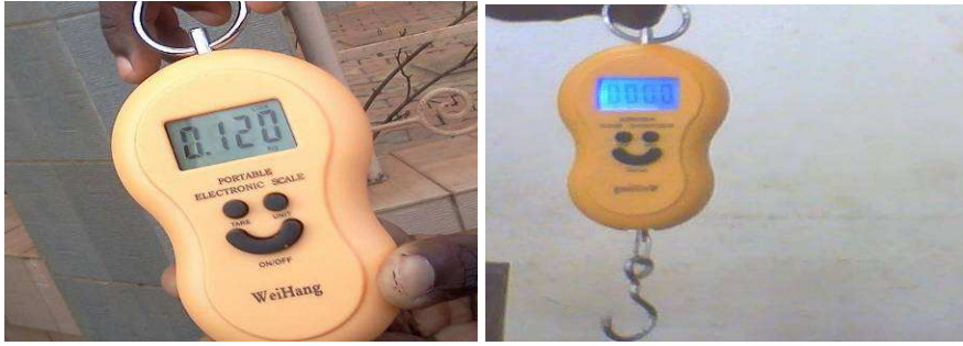
Planche 1 : Pèse poids utilisé pour peser les déchets sur le terrain.
