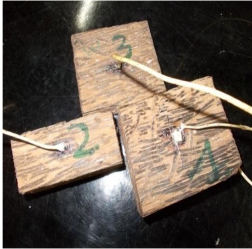
Figure 1 : Echantillons pour la mesure de la diffusivité thermique.
