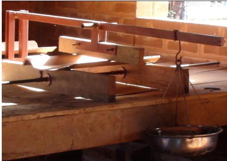
FIGURE 6.1: Vue du dispositif des essais de résistance à la flexion 3 points.
