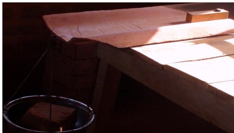
FIGURE 6.2: Vue du dispositif des essais de résistance aux chocs.
