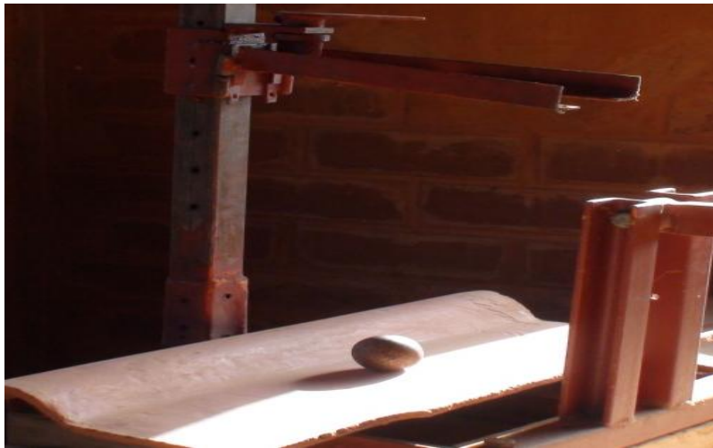
FIGURE 6.2: Vue du dispositif des essais de résistance aux chocs.
