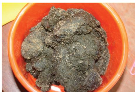
Photo 2 : Echantillon de boues déshydratées obtenu sur un pilote de déshydratation mis en place dans le cadre de cette étude Prise de vue : Liady M. N. D., Août, 2015
