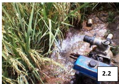
Planche 2 : Motopompe avec tuyau (2.1) et Irrigation d'un champ de riz à partir du forage et à l'aide d'une motopompe (2.2)
