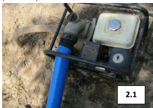
Planche 2 : Motopompe avec tuyau (2.1) et Irrigation d'un champ de riz à partir du forage et à l'aide d'une motopompe (2.2)
