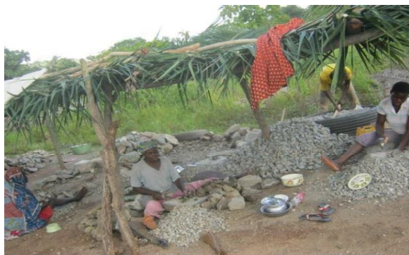
Photos 7 : Concassage des blocs granito-gneissiques dans les banlieues de la ville de Dassa Prise de vue : MAKPONSE, septembre 2014
