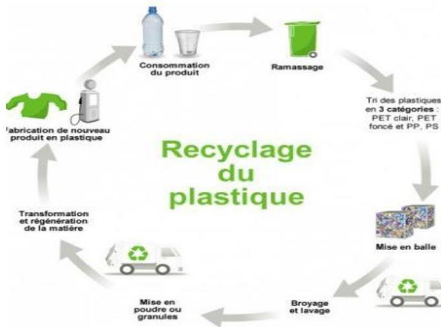
Figure 19: Schéma de recyclage du plastique [26]
